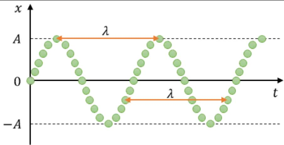
Если известны период и скорость распространения волны, то, согласно первому варианту определения, длины волны равна произведению ее скорости и периода.
