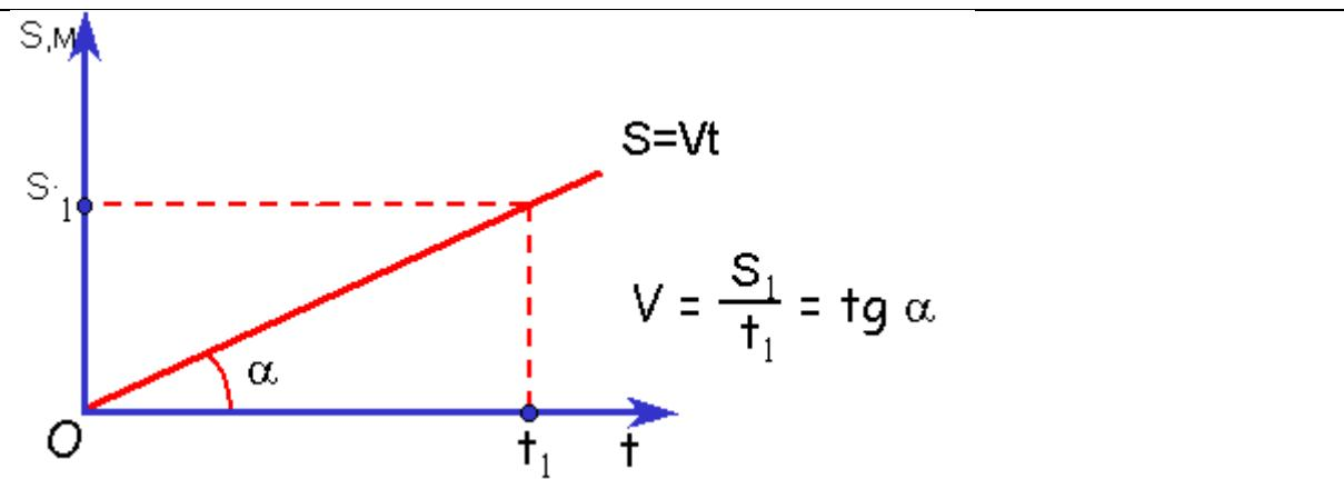
Зависимость координаты от времени. График  $x(t)$  - наклонная линия:
