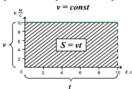
*Правило определения пути по графику  $v(t)$ :* при прямолинейном равномерном движении модуль вектора перемещения равен площади прямоугольника под графиком скорости.
