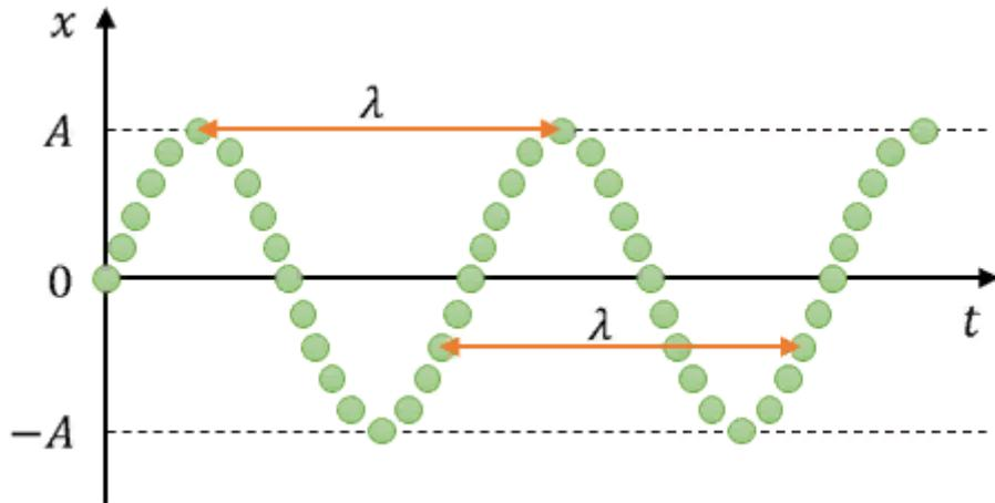
Если известны период и скорость распространения волны, то, согласно первому варианту определения, длина волны равна произведению ее скорости и периода.
