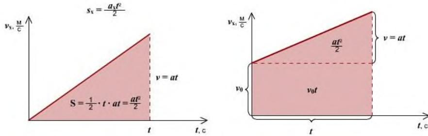
*Правило определения ускорения по графику  $v(t)$ : Ускорение тела - это тангенс угла наклона графика к оси времени. Если тело замедляет движение, ускорение отрицательное, угол графика тупой, поэтому находим тангенс смежного угла.*
