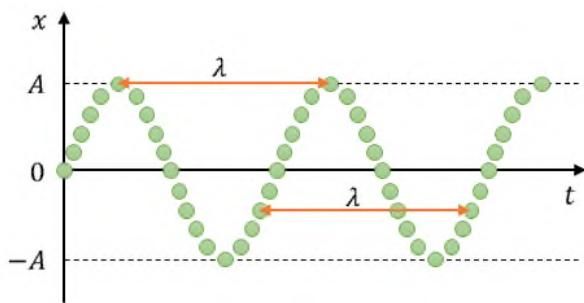
Если известны период и скорость распространения волны, то, согласно первому варианту определения, длины волны равна произведению ее скорости и периода. одинаковой частоты с постоянной разностью фаз.
