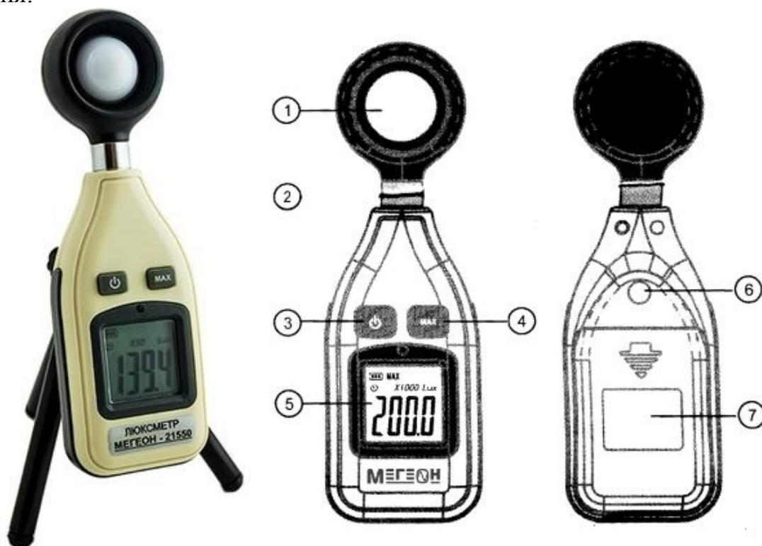
Рисунок 5 – Люксметр МЕГЕОН 21550, где а – внешний вид, б – описание прибора, где 1 – датчик, 2 – металлический соединительный стержень, 3 – кнопка включения/ выключения, 4 – кнопка (MAX) – удерживать для измерения, 5 – ЖК-дисплей, 6 – резьбовое соединение для крепления штатива, 7 – крышка отсека для батареи
