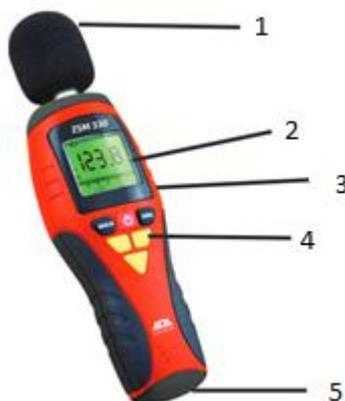
Рисунок 4 - Шумомер ADA ZSM 330 , где 1 – микрофон, 2 – ЖК дисплей, 3 – звуковой выходной разъем, 4 – кнопки управления, 5– крышка батарейного отсека
