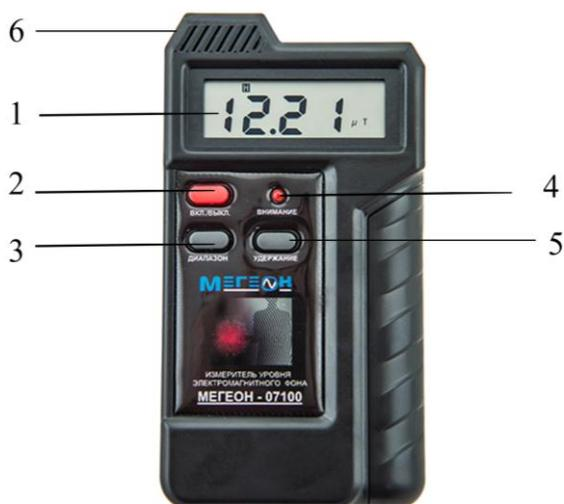
Рисунок 6 - Измеритель уровня электромагнитного фона МЕГЕОН 07100, где 1 – ЖК-дисплей, 2 – кнопка включения/выключения, 3 – кнопка переключения между режимами измерения электрического и магнитного излучения «ДИАПАЗОН», 4 – светодиод предупредительный «ВНИМАНИЕ», 5 – кнопка фиксации значения «УДЕРЖАНИЕ», 6 – приемник.
