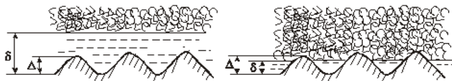
Рисунок 6.4 – К понятию «гладкой и шероховатой трубы»
