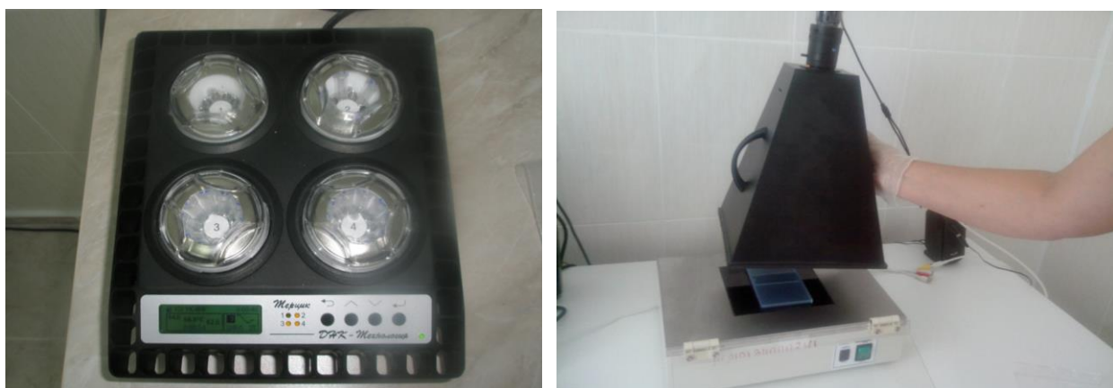
Рисунок 5. Термостат программируемый для проведения ПЦР-анализа, амплификатор и визуализация электрофореграмм на трансиллюминаторе
