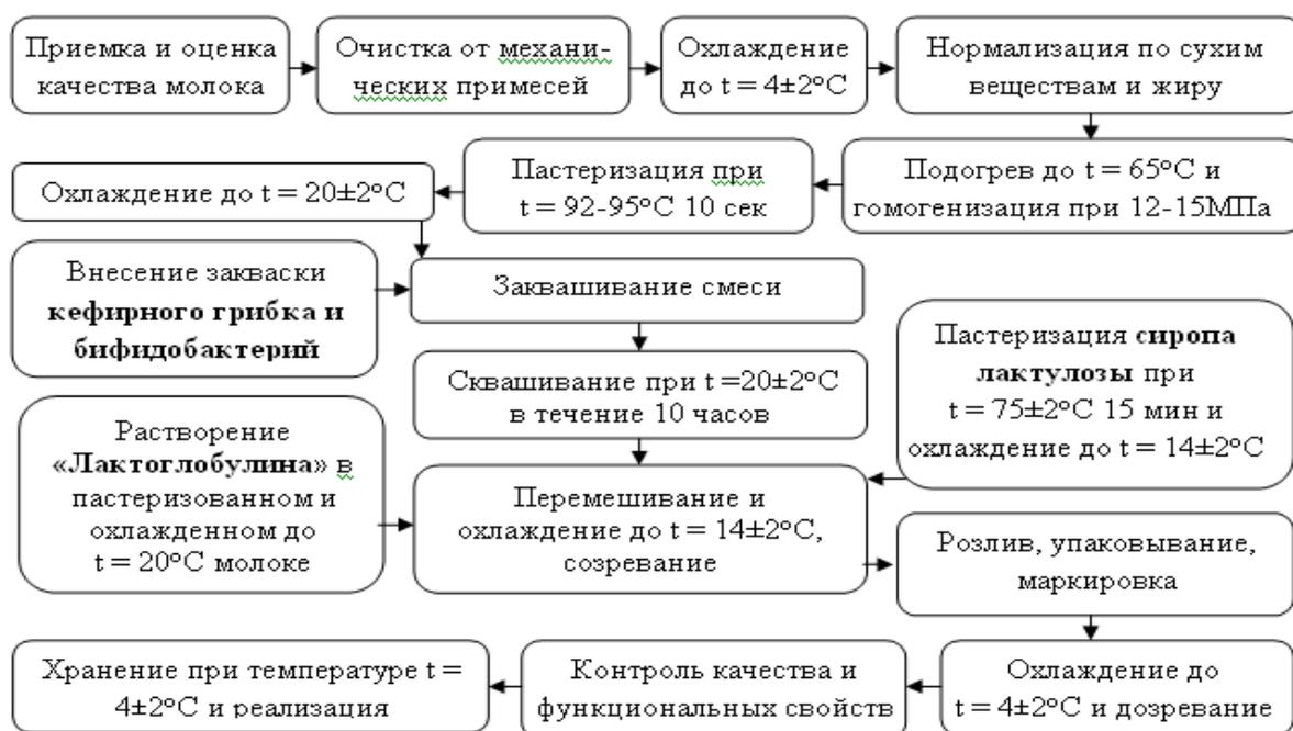
Рис. 1 - Технологическая схема производства кисломолочных биопродуктов "Иммулакт" резервуарным способом.
