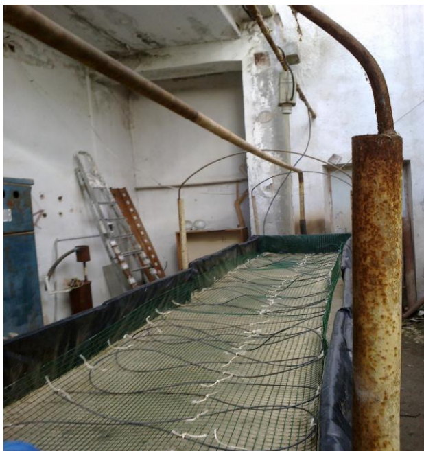
Рисунок 1 – Нагревательные элементы для поддержания автоматической температуры в субстрате
